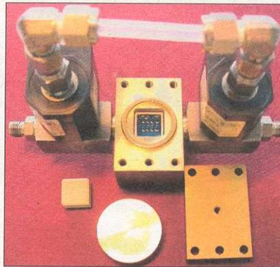
Testkammer mit den beiden Ventilen und der Bypass-Leitung. In der Kammer liegt ein Neigungssensor auf dem Rücken, daher sind die Anschlusspins sichtbar.
