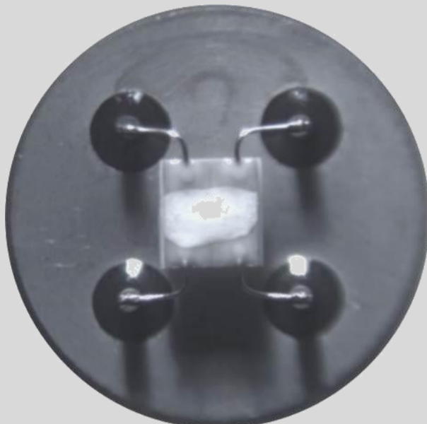
Feuchtesensor des Types GGS 14000
