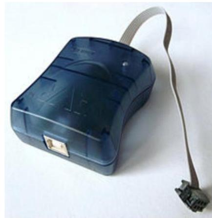
Abbildung 7: ISP Programmiergerät Atmel AVRISP mkII (Quelle: Wikipedia)
