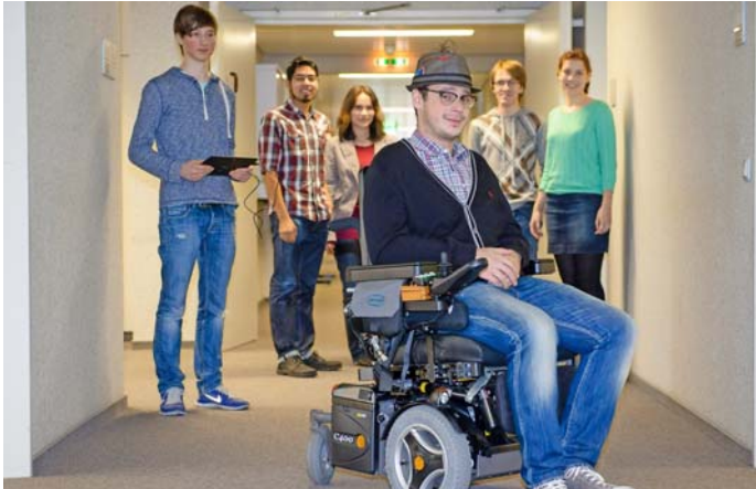
Mit Sensoren an Hut und Rollstuhl kann der Fahrer den Rollstuhl durch Kopfbewegungen intuitiv steuern.
