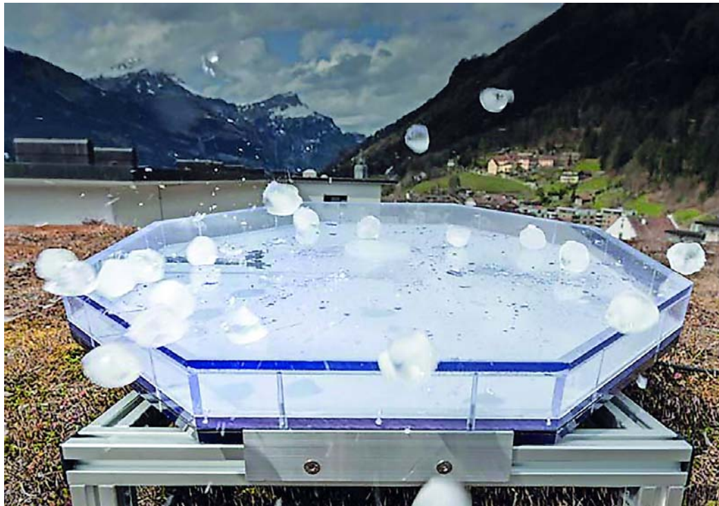
In Deutschland und der Schweiz sind zurzeit etwa 30 dieser Hagelsensoren im Einsatz. Foto: htw saar
